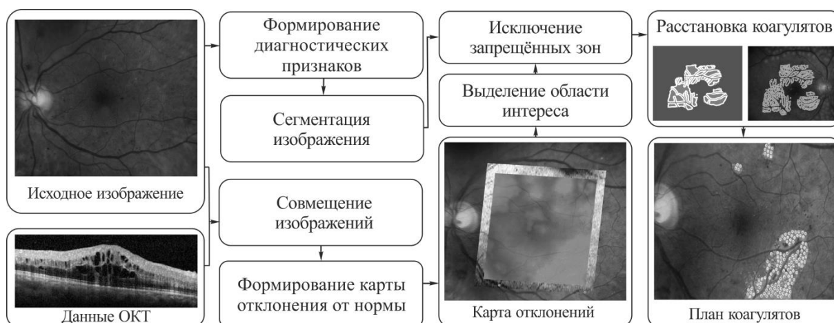
Рисунок 3. Технология формирования плана коагулятов с использованием разработанных методов сегментации изображений глазного дна и расстановки коагулятов
